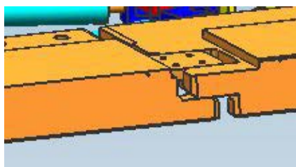
图12 道岔 F 轨搭接
